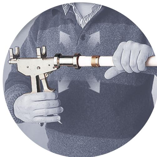
2. Expandir el extremo del tubo con el abocardador P.25 o bien el abocardador Sapress, en cuyo caso hay que rotar el tubo sobre la herramienta a la vez que esta se acciona.
